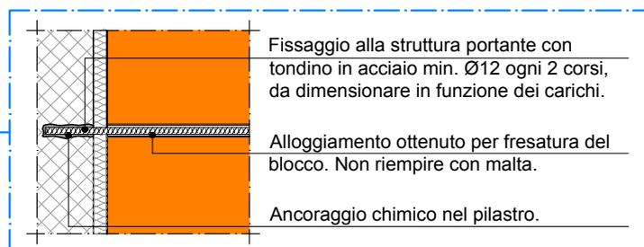
Fissaggio alla struttura portante con tondino in acciaio min.  $\varnothing 12$  ogni 2 corsi, da dimensionare in funzione dei carichi.
