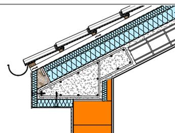
Nodo dell'intersezione della muratura di tamponamento in blocchi GASBETON con il solaio di copertura in legno, con cordolo in c.a.
